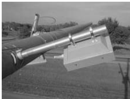
شکل ۳-۳ SAS-1 نصب شده روی بازوی تیرک
